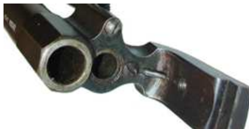
RESORTE DE REGULARIZACION DEL GIRO DEL TAMBOR, EN EL “TRUBIA 1858, 1º TIPO”, SITUADO EN EL APÉNDICE DEL CAÑÓN
