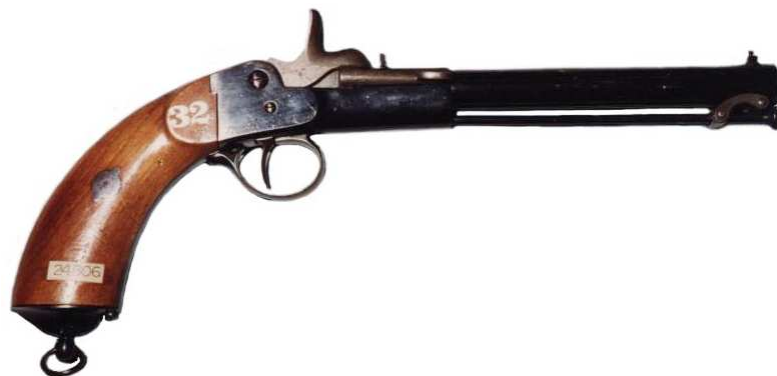
PISTOLA PARA CARTUCHO DE ESPIGA DE 12 mm., MARCADA "J.R.L." Y "TRUBIA 1860". CAÑÓN LONGITUD 191 mm. ÁNIMA CON DIÁMETRO DE 11 mm. , RAYADA COMO LAS ANTERIORES.
