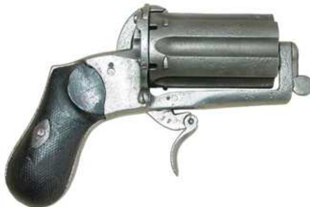
AVISPERO DEPREZ, “SELF-COCKING”, SEIS TIROS, CALIBRE 9 mm, CON MARCA “ORBEA HER. / EIBAR”, NÚMERO 36. “TAMBOR-CAÑÓN” LONGITUD 84 mm
