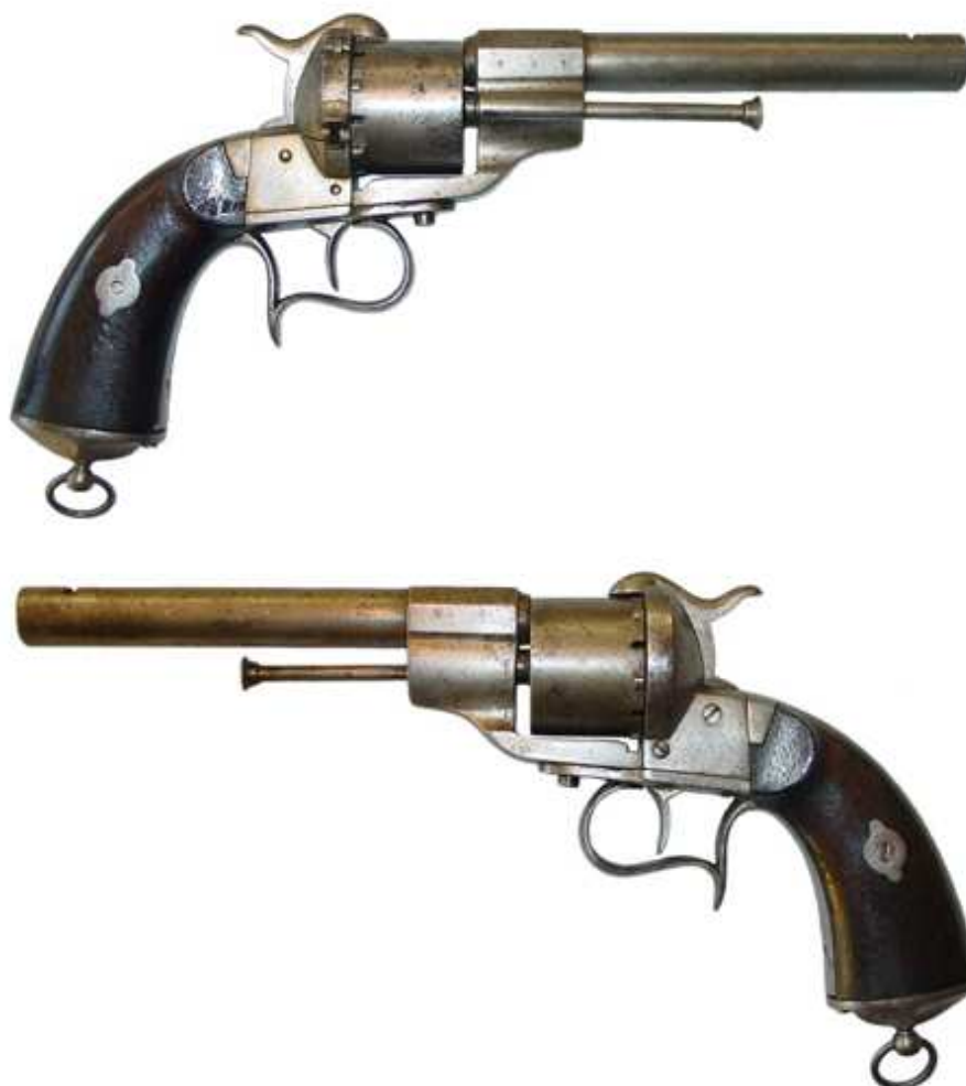
REVOLVER LEFAUCHEUX 1854, MARCADO “RIERA LOPEZ Y COMP a - DURANGO”, N° 302. CAÑÓN LONGITUD 158 mm., DEL QUE SE HA EXTRAIDO EL PUNTO DE MIRA
