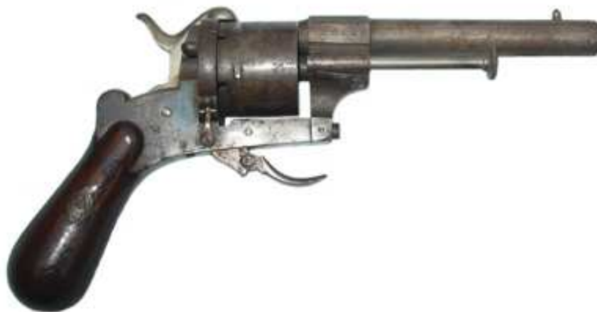
REVOLVER LEFAUCHEUX DE DOBLE ACCIÓN, SEIS TIROS, CALBRE 9 mm. MARCADO “FABRICA / DE / DURANGO”, N° 13962, CAÑÓN LONGITUD 118 mm.
