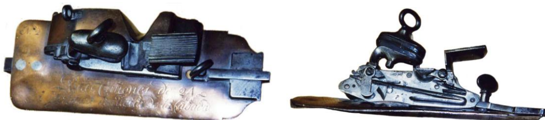
Llave de chispa para el disparo de piezas en la Marina, hacia 1800. La plancha de latón, inscrita: “Nº2 / PARA CAÑÓN DE 24 / FABRICA ARTILLERÍA DE LA CABADA”
