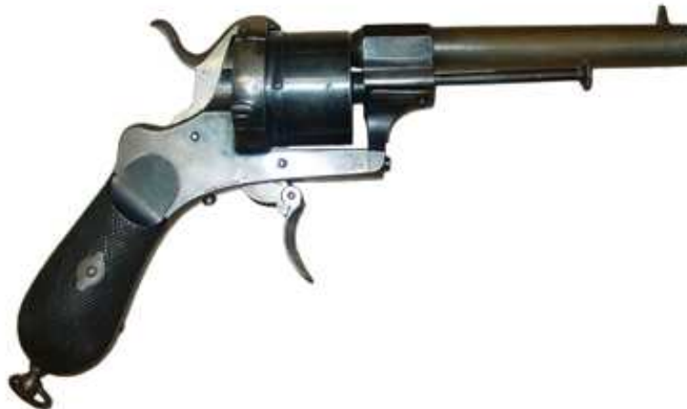
REVOLVER LEFAUCHEUX DE DOBLE ACCIÓN, SEIS TIROS, CALIBRE 12 mm. CON SOLAPA DE SEGURIDAD, MARCADO “BARTHELET Y CHASTANG”
