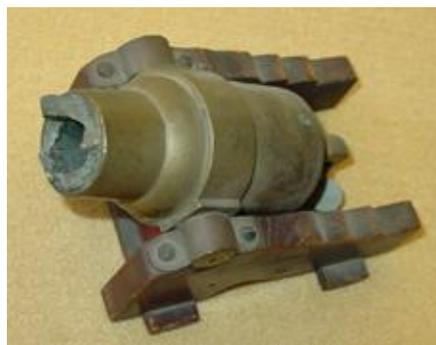
**La utilización de una pólvora menos “viva”, hubiera podido evitar el accidente sufrido por este modelo de cañón**
