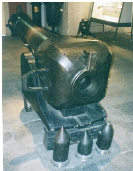
**Cañón Cavalli, rayado, de retrocarga, calibre 165 mm (1846)**
