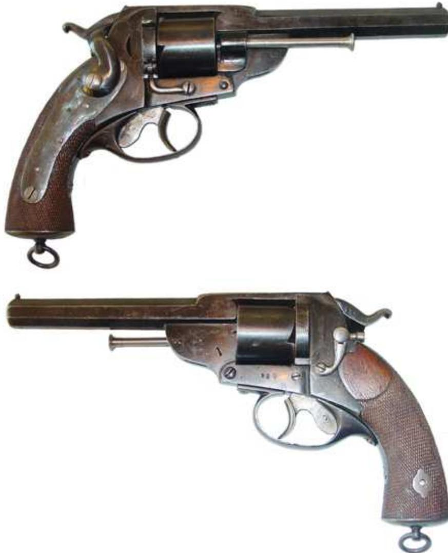
**REVOLVER KERR DE MARINA, Md. 1862, RECOMPUESTO Y TRANSFORMADO PARA LA UTILIZACIÓN DE CARTUCHOS METÁLICOS.**
