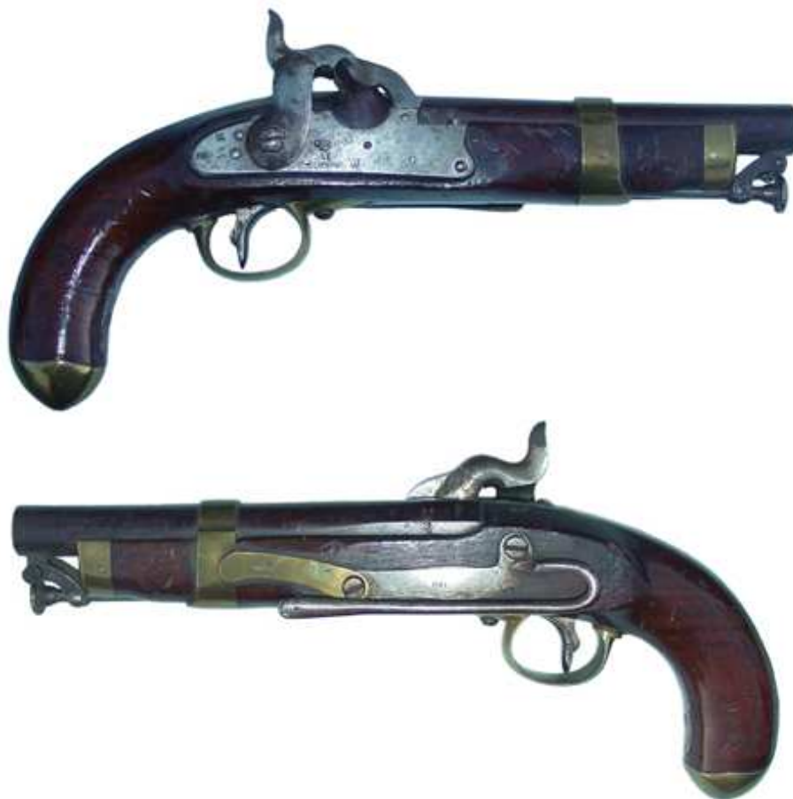
PISTOLA DE CABALLERÍA, MODELO 1852, FÁBRICA DE OVIEDO, NÚMERO 97, FECHADA 1852, CALIBRE DE Á 17 (18 mm.). LONGITUD DEL CAÑÓN: 195 mm.
