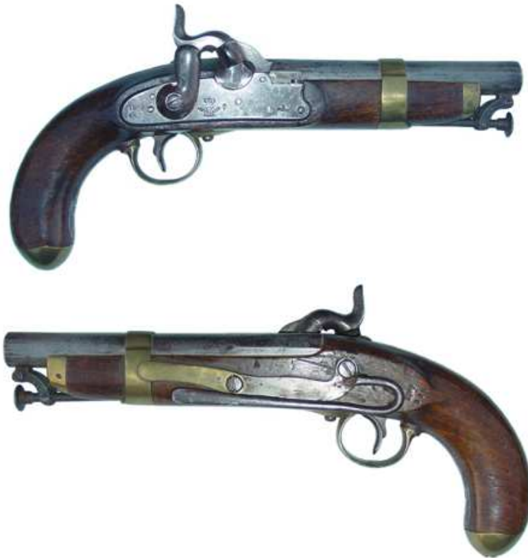
PISTOLA DE CABALLERÍA, MODELO 1852, FÁBRICA DE PLACENCIA, NÚMERO 643, FECHADA 1857, CALIBRE DE Á 17 (18 mm), LONGITUD DEL CAÑÓN: 195 mm.
