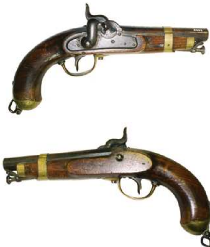
PIEZA Nº 3.007 DE LA COLECCIÓN DEL MUSEO NAVAL, CARENTE DE MARCA DE FÁBRICA Y NÚMERO, CALIBRE DE A 17 (18 mm), LONGITUD DEL CAÑÓN: 173 mm. PROBABLE PROYECTO DE PISTOLA DE MARINA
