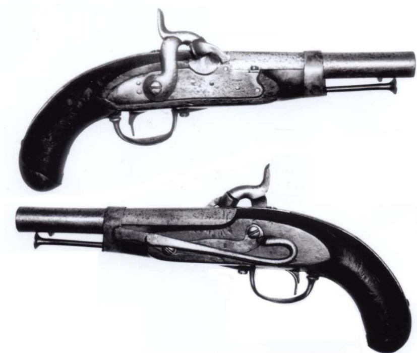
PISTOLA DE CABALLERÍA, MODELO 1839, TRANSFORMADA “MODELO 1849”. CAÑÓN LONGITUD 196 mm. CALIBRE DE Á 15 (19 mm).
