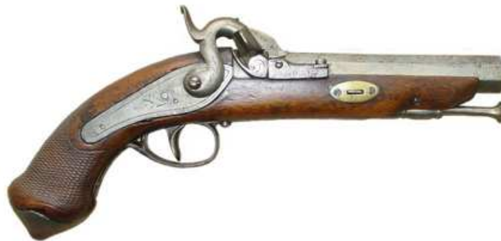
PISTOLA DE PISTÓN, MANUFACTURA TARDÍA. LLAVE SIN RESEÑA DE CONSTRUCTOR. CAÑÓN, LONGITUD 145 mm. INSCRITO EN PLATA: "FABRICA" / "DE PEDRO ORBEA EN EIBAR" / "AÑO 1856", DIÁMETRO DE ÁNIMA 17 mm. (Pedro de Orbea, 1850-1870)
