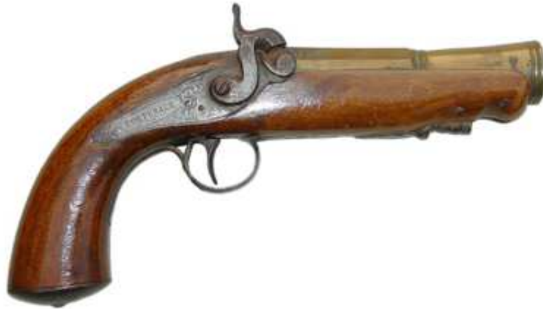
PISTOLA-TRABUCO DE PISTÓN, MANUFACTURA TARDÍA, LLAVE INSCRITA EN PLATA: "PORTUSACH" (Domingo Portusach, Barcelona, 1857-1890) CAÑÓN DE BRONCE, LONGITUD 137 mm. , DIÁMETRO DE ÁNIMA EN LA BOCA 32 mm.
