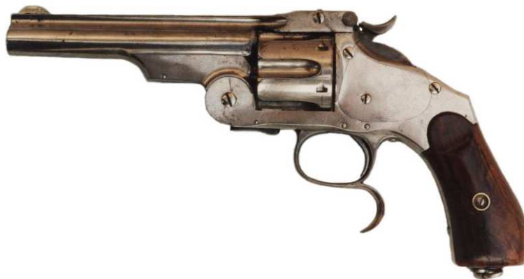
REVOLVER “SMITH & WESSON MODEL 3 RUSSIAN THIRD MODEL”, SEIS TIROS, Cal. 44 “RUSO”, CAÑÓN LONGITUD 131 mm. INSCRITO “ORBEA HERMANOS (EIBAR) CON PRIVILEGIO EN ESPAÑA”, NÚMERO 630
