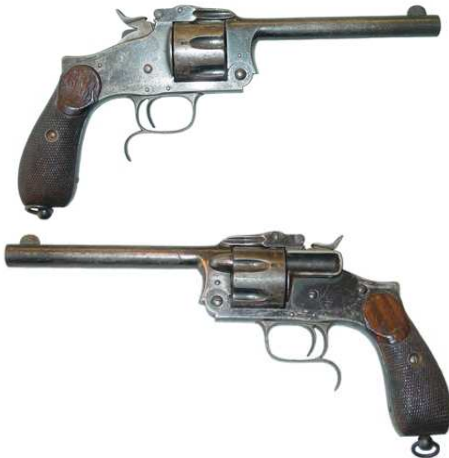
REVOLVER CON SISTEMA DE EXTRACCIÓN GASEOSA IBARRA, SEGUNDO PROYECTO PIÑAL. SIETE RECÁMARAS, CALIBRE 9 mm. CAÑÓN LONGITUD 146 mm.
