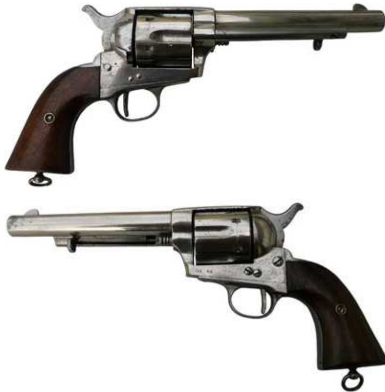
REVOLVER “COLT 1872”, EIBARRÉS, ACCIÓN SIMPLE, SEIS TIROS, CAL 44, CAÑÓN LONGITUD 150 mm. INSCRITO “SYSTEM REVOLVER V. ARIZM. MANUFACTURER OF FIRE ARMS” (Vicente Arizmendi, 1880-1894)
