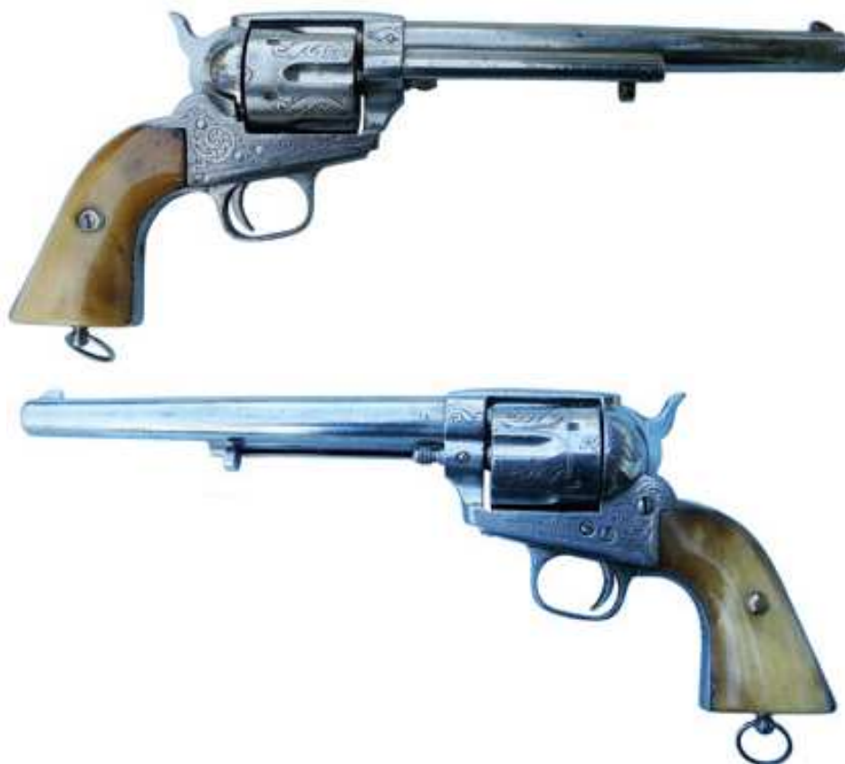
REVOLVER "COLT 1872" EIBARRÉS, ACCIÓN SIMPLE, SEIS TIROS, CALIBRE 44, CAÑÓN LONGITUD 195 mm. INSCRITO "COLT'S CAL. 44 TERE THOSE THAT / FIT BEST EUSKARO REVOLVER", NÚMERO 33. MANUFACTURA ANÓNIMA
