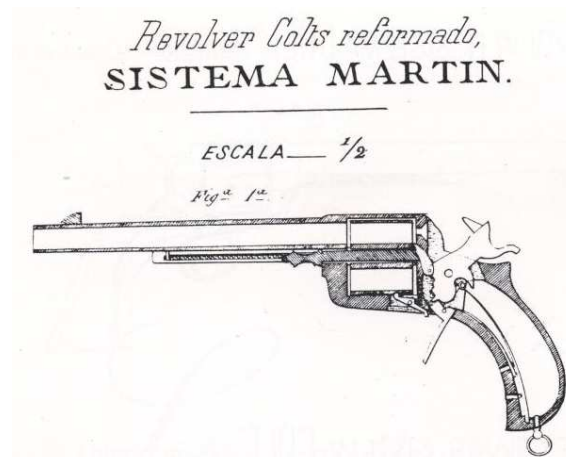
DISEÑO DEL REVOLVER “COLTS REFORMADO, SISTEMA MARTIN”, CON DISPARADOR ABATIBLE, PATENTADO EN 1887 POR MARTÍN ANTONIO BASCARAN
