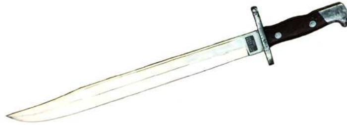
MACHETE-BAYONETA, PROYECTO DE LA FÁBRICA DE TOLEDO PARA ARMAMENTO MAUSER UTILIZADO EN LOS CUERPOS DE ARTILLERÍA Y DE INGENIEROS. HOJA ALFANJADA (398 x 35 mm), MARCADA “ARTILLERÍA / Fca. DE TOLEDO / 1899”
