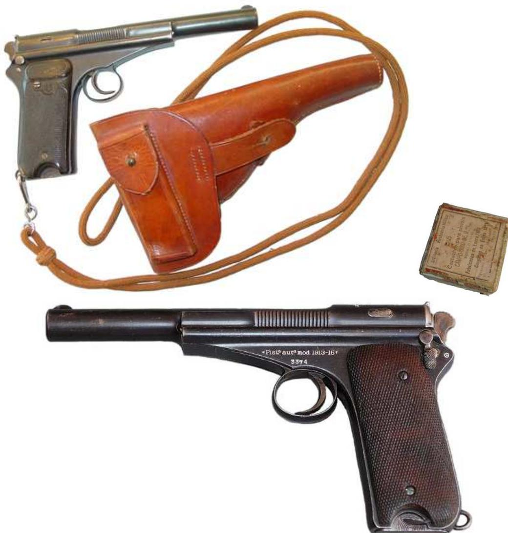
**PISTOLA CAMPO-GIRO MODELO 1913-16, CALIBRE 9 mm CAMPO-GIRO, A ALIMENTAR MEDIANTE CARGADOR CON CAPACIDAD PARA OCHO CARTUCHOS. LONGITUD DEL CAÑÓN 165 mm. MARCAS: “CAMPO-GIRO / PAT. 34798-54214”, EMBLEMA DE ESTADO MAYOR, “ESPERANZA Y UNCETA / GUERNICA” Y “Pistª Autª mod. 1913-16”. (Foto H. Meruelo)**
