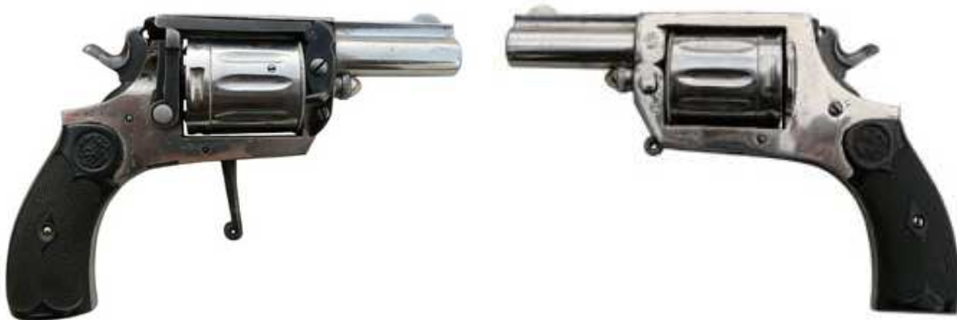
REVOLVER DE BOLSILLO, CON SISTEMA AUTOMÁTICO DE EXTRACCIÓN DE VAINAS, PATENTADO POR FÉLIX GABILONDO EL AÑO 1904. DOBLE ACCIÓN, CINCO TIROS, CALIBRE 8 mm “LEBEL”, CAÑÓN LONGITUD 55 mm. MARCADO “LEBEXTRA”, CON LOGO “IHC”, NÚMERO 161. EN LAS CACHAS, LOGO “JBC”.
