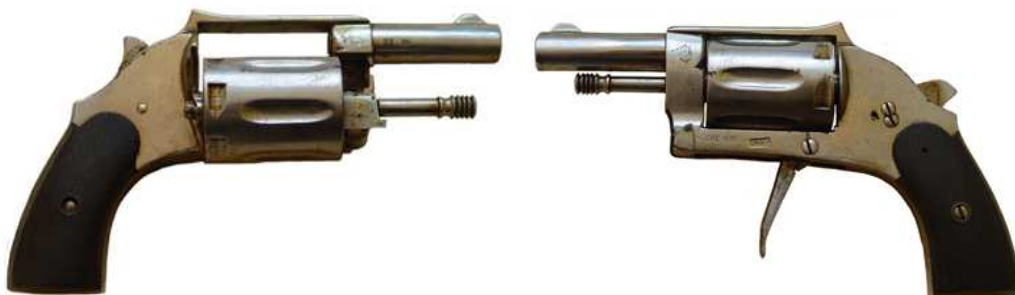
REVOLVER “OSCILANTE” DE BOLSILLO, DOBLE ACCIÓN, CINCO TIROS, INSCRITO “CAL 6,35 mm”, CAÑÓN LONGITUD 50 mm. CON LOGO “FA” (Francisco Arizmedi). OFERTADO POR “F. ARIZMENDI Y GOENAGA” EN SU CATÁLOGO DE 1913-14, COMO REVOLVER “PHENIX”, EN CALIBRE 6 mm “VELO-DOG” O EN EL 8 mm. “LEBEL”. SE DEDUCE FABRICADO, POSTERIORMENTE, PARA CARTUCHOS 6,35 mm BROWNING, SIN REDUCIRSE LA LONGITUD DEL TAMBOR
