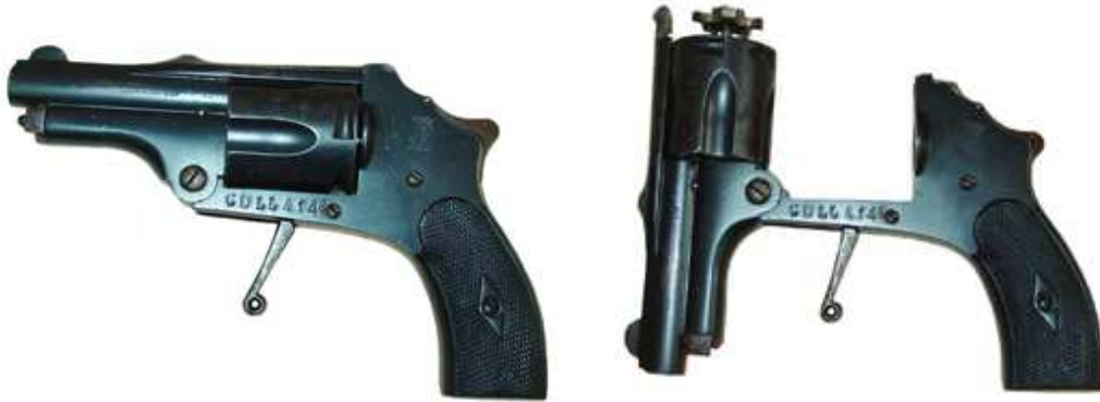
REVOLVER DE BOLSILLO “SMITH-HAMMERLESS” CON SISTEMA AUTOMÁTICO DE APERTURA Y EXTRACCIÓN SIMULTÁNEA DE LAS VAINAS, PATENTADO POR LOS HERMANOS MARTÍN Y GREGORIO PAGNON, EL AÑO 1907. CINCO TIROS, CALIBRE 8 mm “LEBEL”, CAÑÓN LONGITUD 64 mm. INSCRITO “VELOMITH EXCELSIOR MODEL 1907” CON LOGO “MAB” (Martín Antonio Bascaran)
