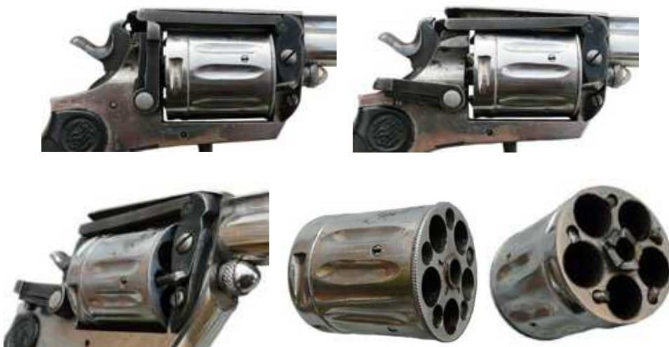
REVOLVER DE BOLSILLO, CON SISTEMA AUTOMÁTICO DE EXTRACCIÓN DE VAINAS, PATENTADO POR FÉLIX GABILONDO EL AÑO 1904. DOBLE ACCIÓN, CINCO TIROS, CALIBRE 8 mm “LEBEL”, CAÑÓN LONGITUD 55 mm. MARCADO “LEBEXTRA”, CON LOGO “IHC”, NÚMERO 161. EN LAS CACHAS, LOGO “JBC”.
