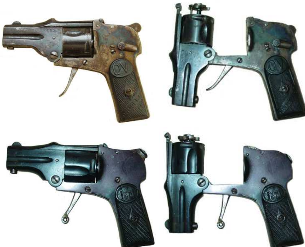
REÓLVERES DE BOLSILLO “SMITH-HAMMERLESS” CON SISTEMA AUTOMÁTICO DE APERTURA Y EXTRACCIÓN SIMULTÁNEA DE LAS VAINAS, CINCO TIROS, CALIBRE 6,35 mm. EL DE ARRIBA, CON SEGURO, COMERCIALIZADO CON LA MARCA “CRUCERO”, CON LOGO “OV” (Ojanguren y Vidosa). EL DE ABAJO, SIN SEGURO, CON LOGO “ME”
