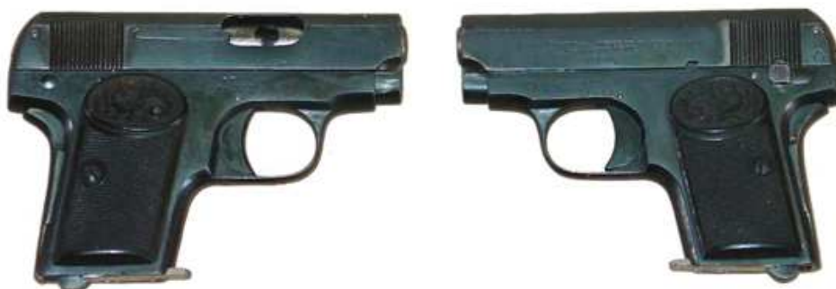
PISTOLA “TIPO EIBAR”, SEIS TIROS, CAÑÓN 62 mm. MARCADA “PISTOLA BROWNING AUTOMATICA CAL 7,65 / ‘APACHE” (la marca APACHE, registrada en 1919 por “Ojanguren y Vidosa”)
