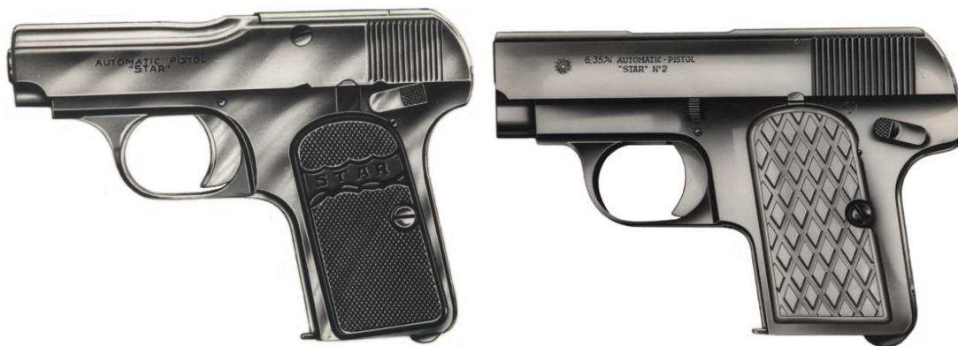
PISTOLAS “STAR N° 2”, Cal 6,35 mm. A LA Izda. EL MODELO INICIAL (1909), A LA Dcha. EL SIGUIENTE. AUN HUBO UN TERCERO (1911) CON DETALLES COMUNES CON LAS “VICTORIA”, DE “ESPERANZA Y UNCETA”
