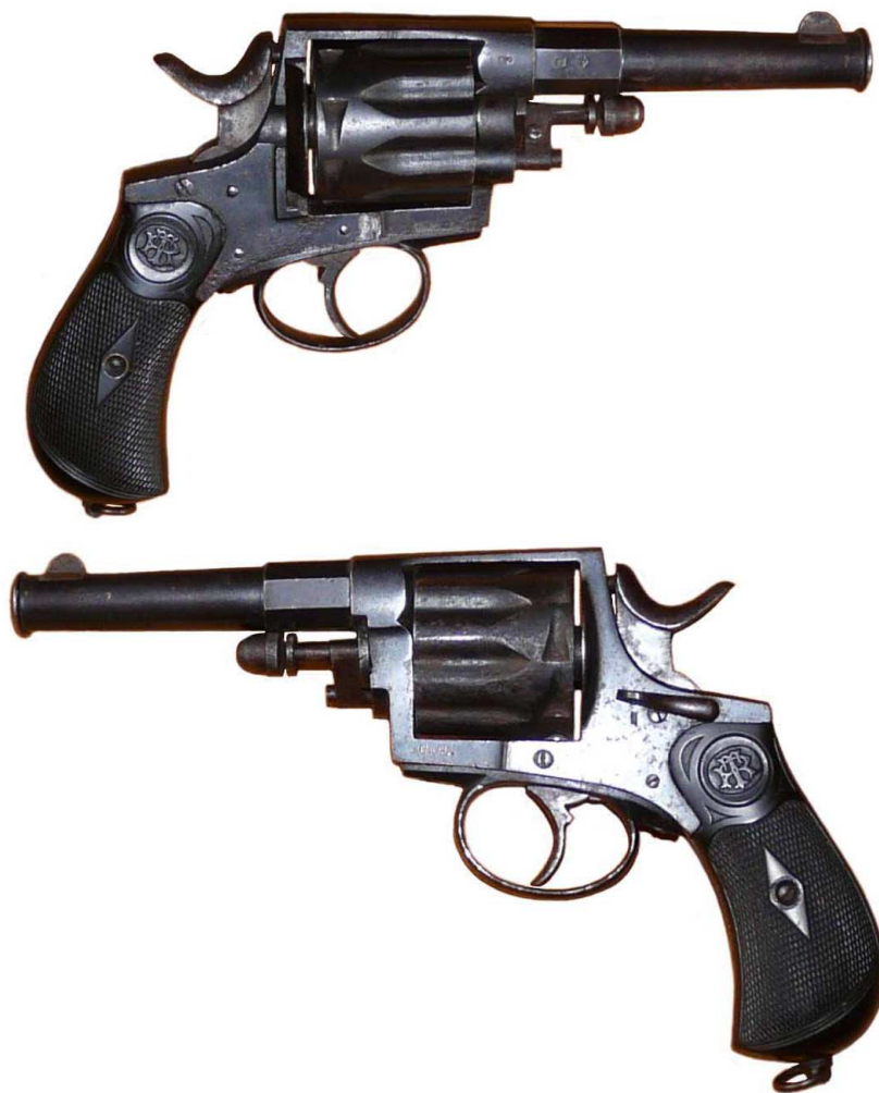
REVOLVER "DE ORDENANZA", NUEVE TIROS, Cal. 8 mm LEBEL, CAÑÓN LONGITUD 107 mm. OFERTADO EN EL CATÁLOGO DE "F. ARIZMENDI Y GOENAGA" COMO MODELO "Nº 149 ORDONNANCE QUALITÉ 1ERE"
