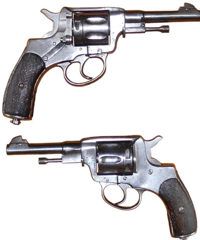
REVOLVER “NAGANT” EIBARRÉS, VARIANTE SIN AVANCE DEL CILINDRO, SIETE TIROS, Cal. 7,62 NAGANT, CAÑÓN LONGITUD 104 mm. CON LOGO DE LA FIRMA “F. ARIZMENDI Y GOENAGA”, OFERTADO EN SU CATÁLOGO COMO MODELO “DE OFICIAL”
