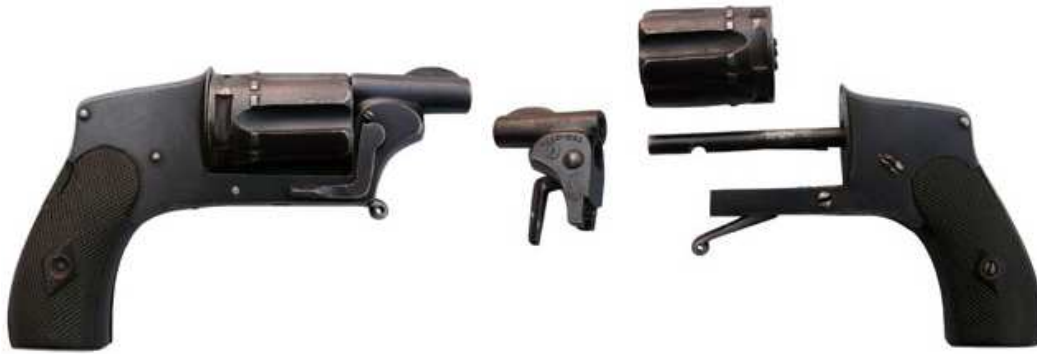
REVOLVER “VELO-GAL”, SEIS TIROS, CALIBRE 6 mm VELO-DOG, CAÑÓN LONGITUD 31 mm. CON MARCA “VELO-GAL” Y LOGO DE FRANCISCO ARIZMENDI
