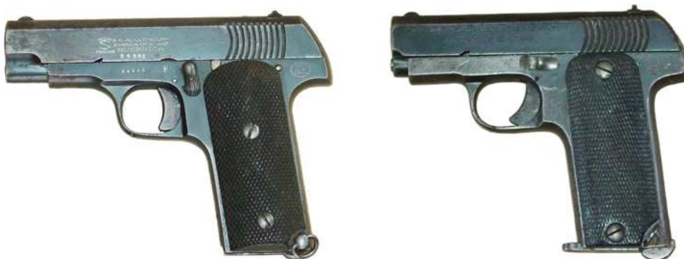
PISTOLAS TIPO “RUBY”, NUEVE TIROS. Izda. EJEMPLAR MARCADO “S.A. ALKARTASUNA / FABRICA DE ARMAS / GUERNICA”, LOGO “ALKAR”. Dcha. EJEMPLAR MARCADO “7,65 1914 MODEL AUTOMATIC PISTOL / M. ZULAICA & C° EIBAR”
