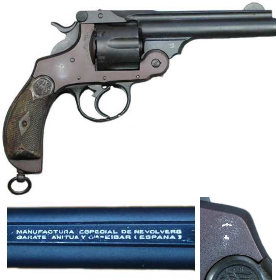
REVOLVER MODELO “PISTOL O.P. WHIT FIVE INCH BARREL No1 MARK 1”, CON LOGO “GAC”, MARCA DE FÁBRICA Y “FLECHA” DE ACEPTACIÓN BRITÁNICA (Foto H. Meruelo)
