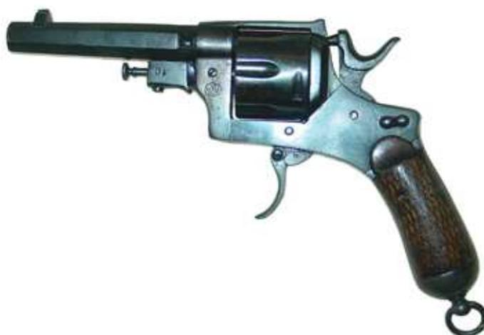
REVOLVER BODEO Md. 1889, DOBLE ACCIÓN, SEIS TIROS, CALIBRE 10,35 mm.
