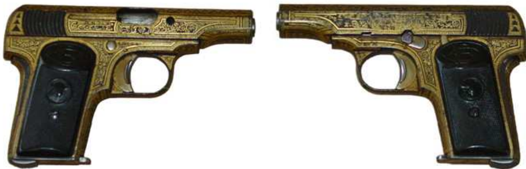
PISTOLA “BUFALO”, Cal. 7,65 mm. SIETE TIROS, CAÑÓN LONGITUD 85 mm. MARCADA “PISTOLA AUTOMATICA ESPAÑOLA PATS. 62004 Y 67577 / ‘BUFALO’ 7,65 – 32 CAL”, LOGO “BC” (Beristain y C a )
