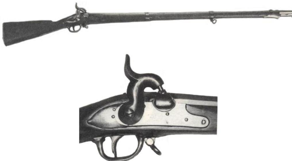
**Ejemplar del modelo de fusil de pistón, “con culatín”, calibre de á 17 (18 mm), construido en Oviedo el año 1834, en número de 500 ejemplares, para armar un batallón por vía de ensayo. Pieza nº 1997 en el Catálogo del Museo de Artillería, ilustrada en el último trabajo de Barceló**
