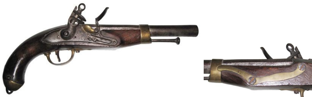
Pistola de caballería, modelo 1815, calibre “de á 17”, cañón longitud 230 mm. Llave “mejorada en 1812”. Ejemplar producido en la fábrica de Placencia, sin fecha.
