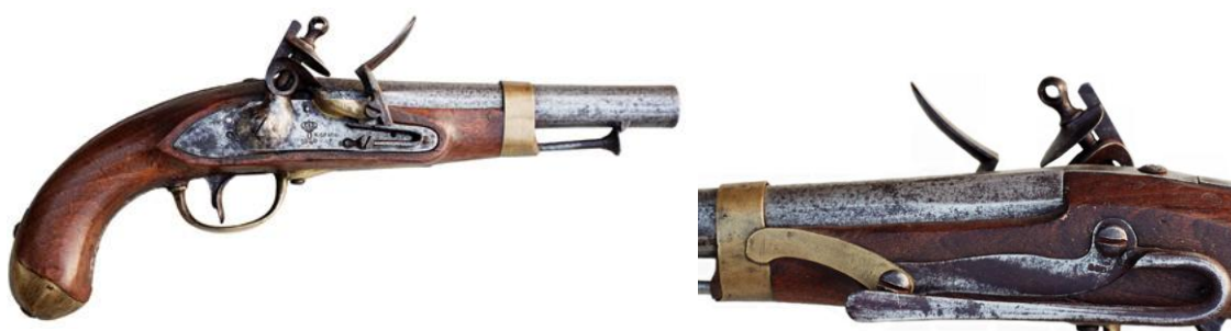
Pistola de caballería, modelo 1839. Calibre “de á 15”, cañón longitud 196 mm. Llave modelo 1828, con marca de la Fábrica de Oviedo, fechada en 1840.
