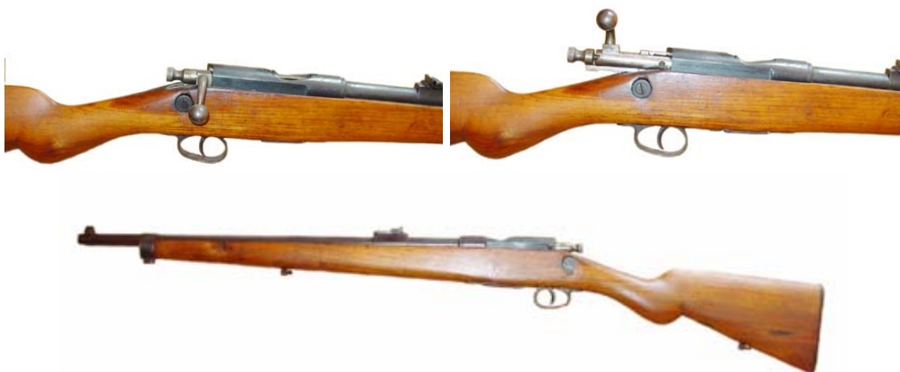
PIEZA Nº 1962-508: CARABINA DE REPETICIÓN “MONTSERRAT”, PARA CARTUCHOS 9 mm BERGMANN. MARCADA PATENTE GENOVA – MARCA MONTSERRAT – GAZTAÑAGA CONSTRUCTOR. Nº291. LONG. DEL CAÑÓN 637 mm, TOTAL 1.040 mm
