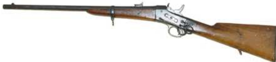
PIEZA N° 2000-141: Tercerola Remington Md. 1871, cara cartuchos 11 mm. Md. 1871, marcada “AR. O.” (Artillería – Oviedo) fecha 1875, número 47. Longitud del cañón: 58,5 cm. longitud total del arma: 96 cm.
