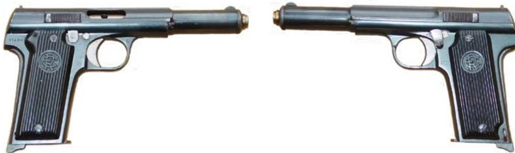
**PIEZA N° 1966-87 : Pistola semi-automática modelo 1921, en variante “R.E.”, para cartuchos Cal 9 mm. Lgo., número de fabricación 11408**
