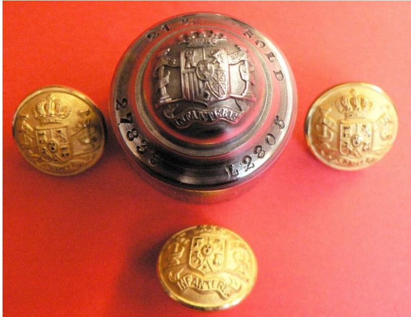
Matriz para botones de oficial de Infantería de los modelos usados entre 1874 y 1931. Realmente sorprende la minuciosidad del trabajo.
