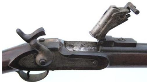
**Cierre Berdan Md. 1867, utilizado en la transformación a retrocarga de carabinas Md. 1857 y fusiles Md. 1859**
