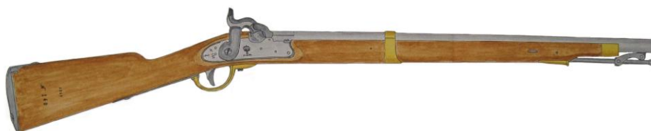
Tercerola Md. 1846. Fábrica de Oviedo, 1847. Cañón longitud 630 mm, calibre “de á 17” (18 mm)
