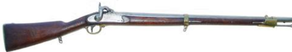
Carabina de Marina, Md. 1847. Fábrica de Placencia, 1848. Cañón longitud 780 mm, calibre “de á 17” (18 mm). Pieza n° 1962-1565 en la Colección del M.M.M.
