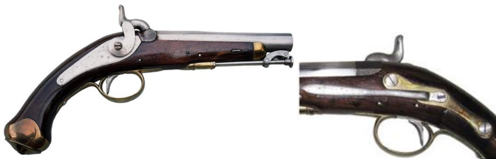
Pistola de gendarmería, de fabricación contratada a Ybarzabal para los Guardas del Real Patrimonio, con ejemplares fechados en 1850 o 1862. Cañón longitud 169 mm, calibre “de á 21” (16,5 mm), inscrito “ Real Patrimonio ”
