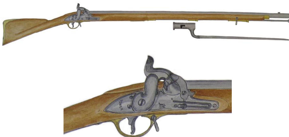
Fusil transformado Md. 1847 “inglés”. Cañón longitud 990 mm calibre “de á 15” (19 mm)
