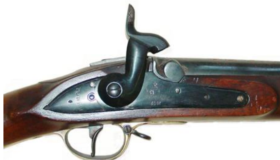
Fusil transformado Md. 1858 “inglés” (con caja de “culata llena”). Cañón longitud 990 mm, calibre “de á 15” (19 mm). Pieza nº 2000-137 en la Colección del M.M.M. (Falta la chimenea)
