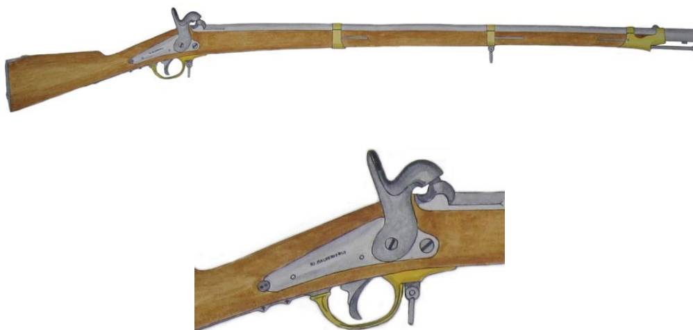
Fusil “modelo belga” (1854-56). “P.J.MALHERVE & CIE / A LIEGE” Cañón longitud 998 mm Calibre “de á 15” (19 mm).
