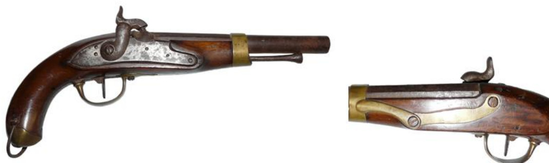
Pistola de caballería, Md. 1815, transformada según Md. 1858. Cañón longitud 230 mm Calibre “de á 17” (18 mm)
