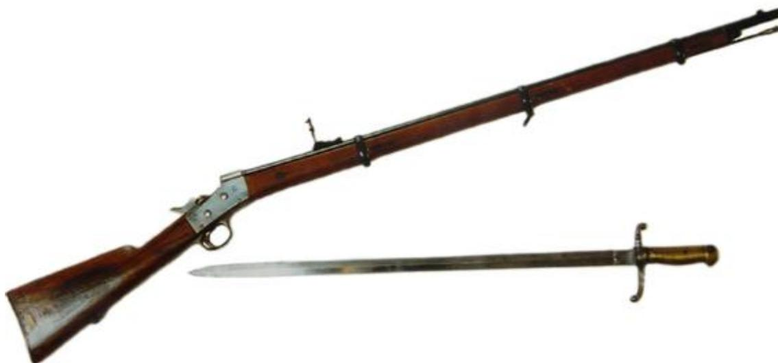
**Fusil Remington Md. 1871, adaptado al uso de los Guardias de S.M. Amadeo I. Fca. de Oviedo, 1870. Cañón longitud 900 mm. calibre 11 mm, con espada bayoneta con hoja de doble filo en dos mesas, longitud 704 mm. inscrita "Fca. DE TOLEDO / AÑO DE 1871. Pieza nº 4759 en la Colección del M.E.**
