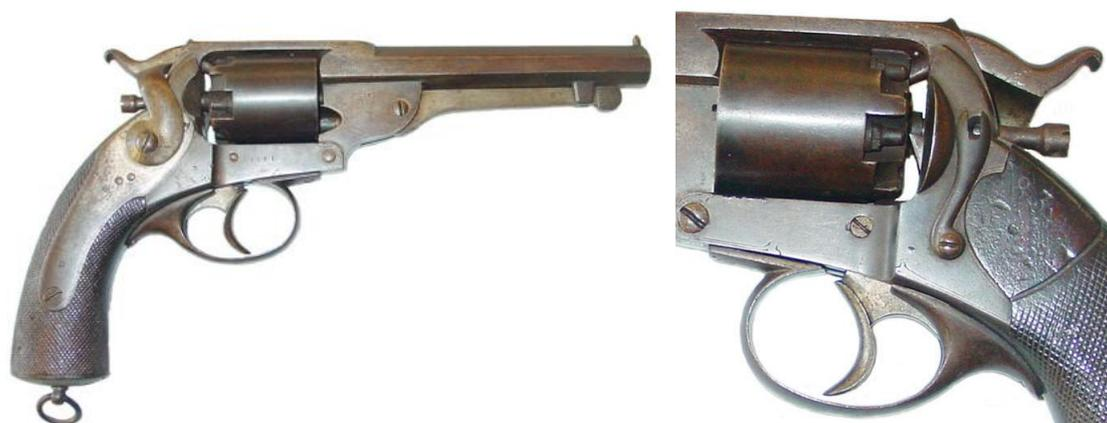
**Revolver Kerr para Marina, modelo 1862. Cinco tiros, calibre 11 mm. cañón longitud 145 mm, con marca de prueba “EX. P”, n° 1481**
