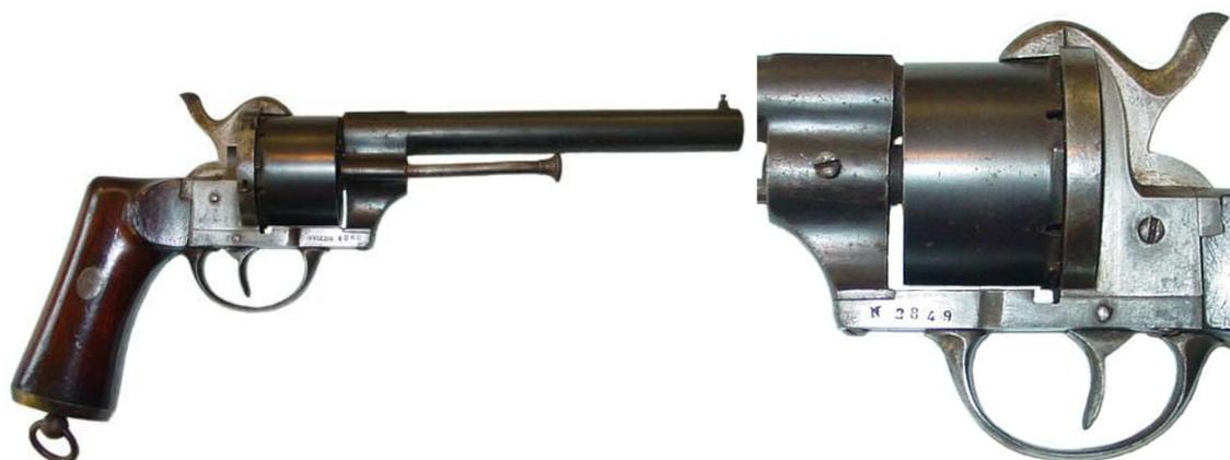
**Revolver Lefauchaux, modelo 1863. Acción simple, seis tiros, calibre 11 mm. cañón longitud 153 mm. ejemplar n° 3849 marcado “OVIEDO”, con fecha 1868.**
