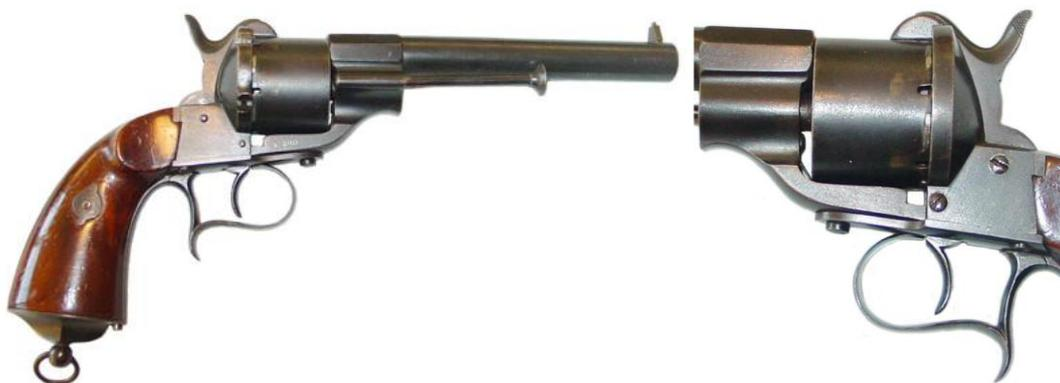
**Revólver Lefaucheux, modelo 1858 de la fábrica de Trubia, 1º tipo (1858-60). Acción simple, seis tiros, calibre 11 mm. cañón longitud 156 mm. ejemplar nº 300 marcado “TRUBIA” con fecha 1859 y “J.R.L.” (José Ramón Larrosa)**
