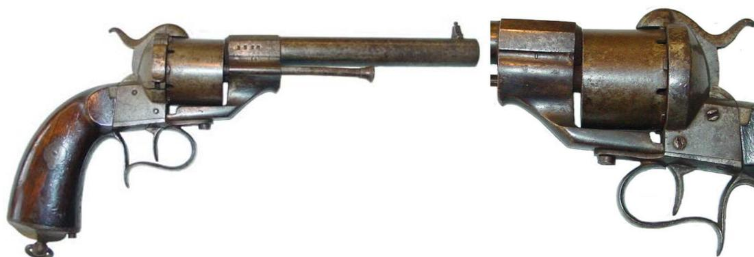
**Revolver Lefauchaux, modelo 1854. Acción simple, seis tiros, calibre 11 mm. cañón longitud 160 mm. ejemplar nº 3820 marcado “ORBEA HERMANOS – EIBAR”.**
