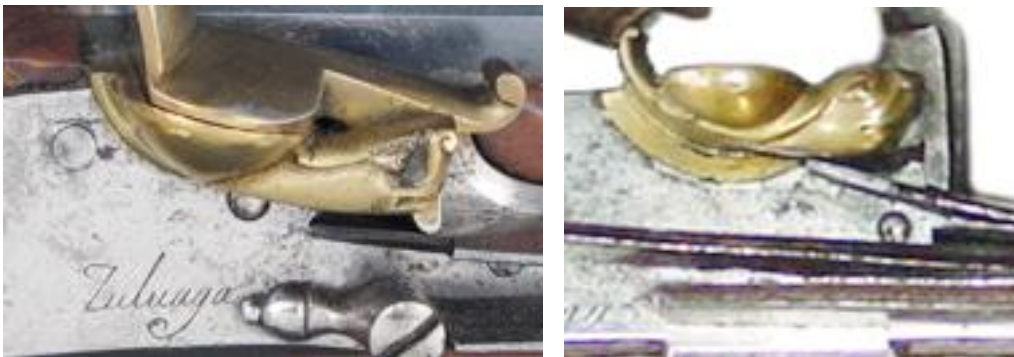
Parecido en el singular acabado de la cazoleta de dos llaves distintas, obra del maestro Zuloaga. A la izquierda, en la llave “á la francesa” de la pistola ilustrada en este escrito; a la derecha, en la llave “á la española” del modelo de pistola construido para equipar a los Oficiales Mayores del Real Cuerpo de Guardias de la Persona del Rey, en servicio durante los años 1824-1841
