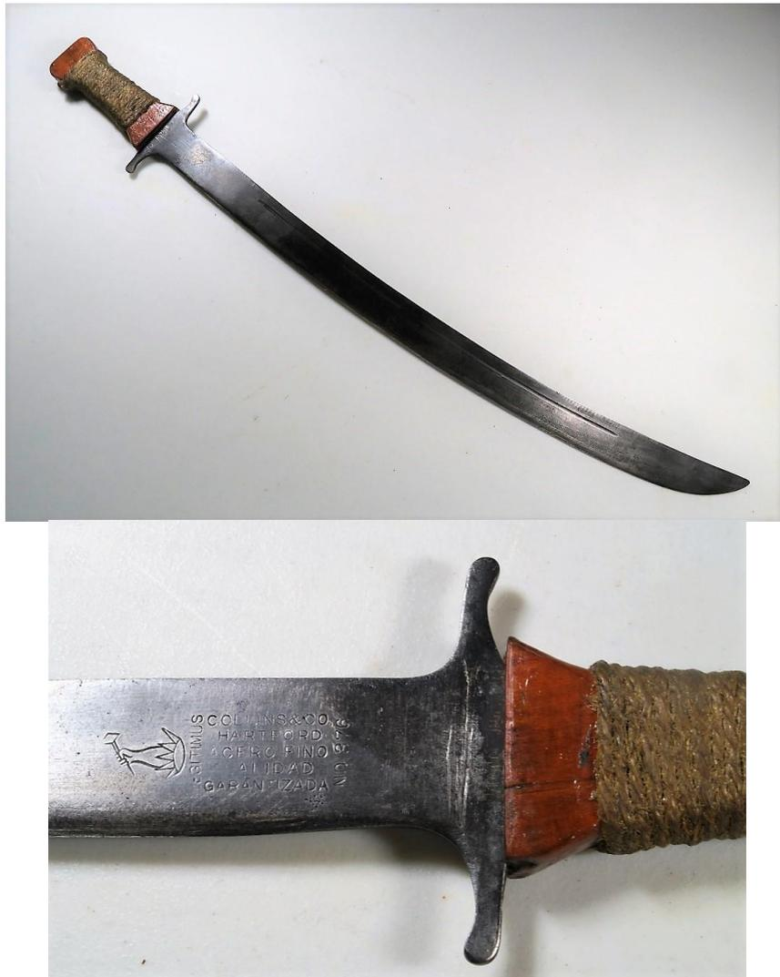
**27)- Collins No.376 “mambí”** con su empuñadura original de asta verde reemplazada eficientemente por dos cachas de madera, encoladas y fuertemente atadas con cordel barnizado. Un machete relativamente corto con largo total de 26” (66 cm) de hoja, guarda y espiga de una sola pieza. Ágil y efectivo en combate, de hoja curvada como un sable. Carece de funda.
