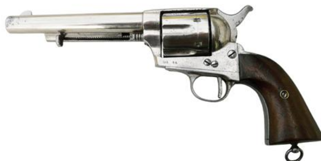
Revolver “Colt 1872” eibarrés, acción simple, seis tiros, calibre 44. Ejemplar con cañón longitud 150 mm (6”), inscrito: SYSTEM REVOLVER V. ARIZM. MANUFACTURER OF FIRE ARMS (Vicente Arizmendi, 1880-1894)
