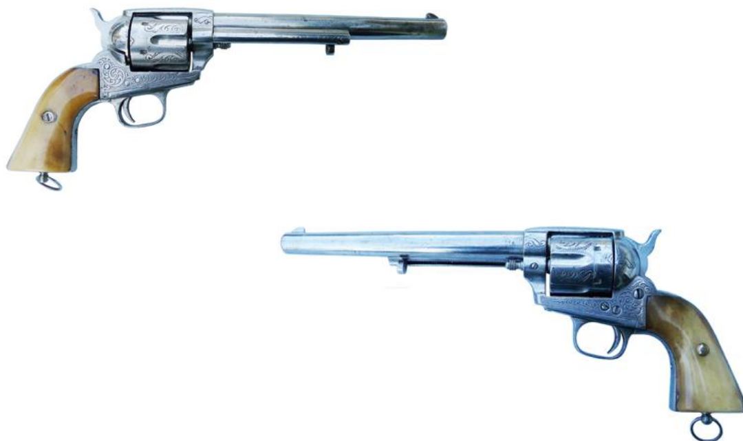
Revolver "Colt 1872" eibarrés, acción simple, seis tiros, calibre 44. Ejemplar con cañón longitud 195 mm (7 ¾"), inscrito: COLT'S CAL. 44 TERE THOSE THAT / FIT BEST EUSKARO REVOLVER, número 33. Manufactura anónima
