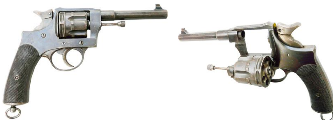
Revolver “ Modèle 1915 ”, doble acción, seis tiros, calibre 8 mm Lebel, logo “AE” en el armazón (Antonio Errasti, Eibar)
