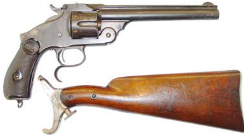
Copia del revolver Smith & Wesson No. 3 New Model, seis tiros, Cal. 44, con culatín adosable, cañón longitud 180 mm inscrito: ORBEA HERMANOS (EIBAR) CON PRIVILEGIO EN ESPAÑA, número 3.189
