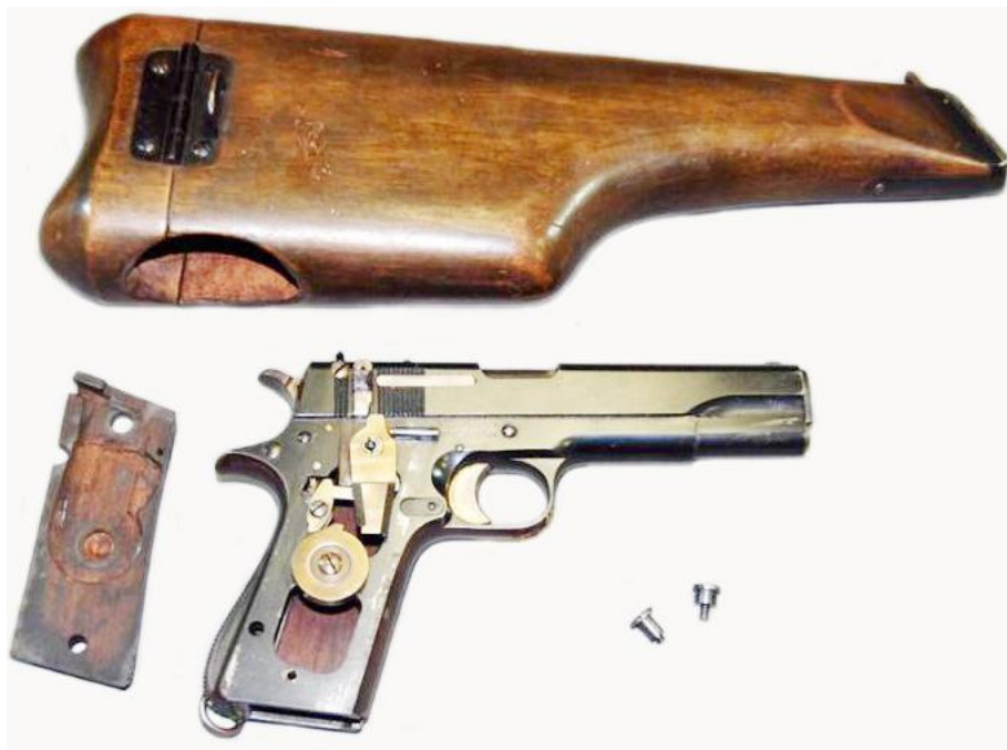
Pistola “STAR” Modelo MD, con selector, para hacer fuego semiautomático o por ráfaga. (Colección Pedro Bello)
