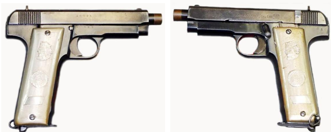
Pistola “PLUS ULTRA” Cal. 7,65 mm con cargador para 22 cartuchos, en variante provista de selector para hacer fuego por ráfaga (Colección Pedro Bello)
