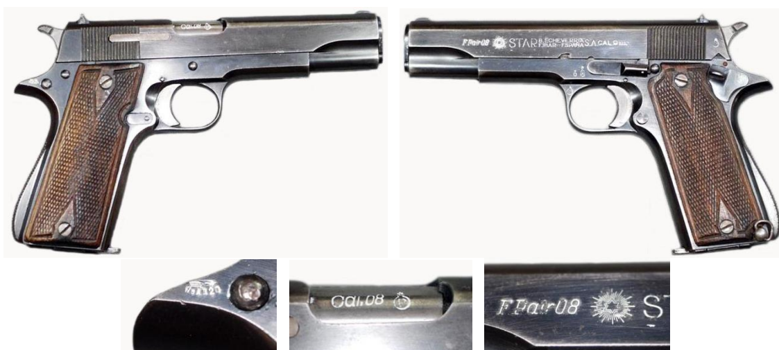
Marcas en una pistola "STAR" modelo B suministrada al Ejército alemán durante la 2ª Guerra Mundial. "WaAD20" (WaffenAmt) "Cal. 08" en el cañón, "F. Patr 08" junto a la marca de fábrica (Fotos H. J. Meruelo)
