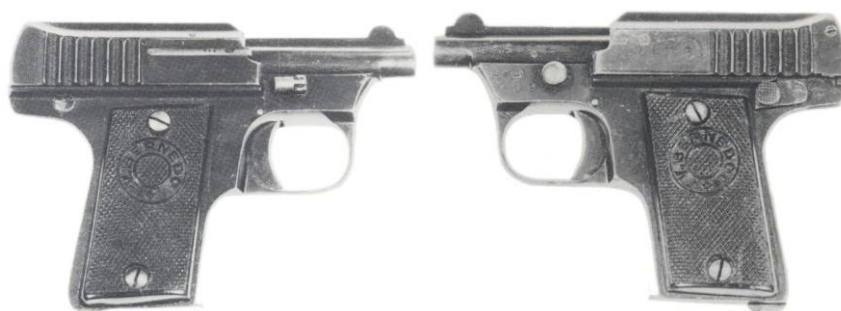
Pistola patentada en 1919 por Victor Bernedo. Siete tiros, calibre 6,35 mm inscrita: “PISTOLET AUTOMATIQUE / BERNEDO / PATENT 69952”
