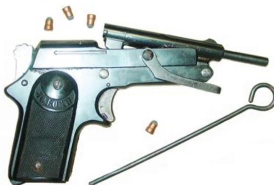
**Pistola "JO. LO. AR" Cal. 6,35 mm, con tubo reductor acoplado, para el disparo de cartuchos Cal. 4 mm. M20, de la "Rheinisch-Westfalische Sprengstoff A.G."**
