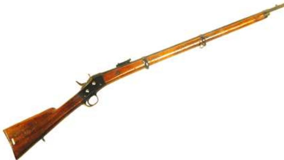
**Carabina modelo 1889, para dragones. Pieza Nº 33782 en la Colección del Museo del Ejército. Producida en la Fábrica de Oviedo el año 1889, dotada de alza de corredera y puente, graduada de 200 a 1.200 metros. Cañón longitud 802 mm. Longitud total del arma 1.175 mm. Ejemplar falto de la baqueta.**
