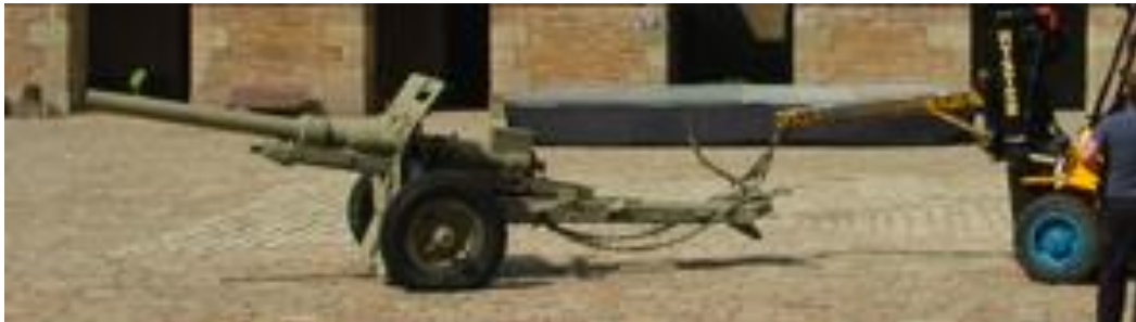
Cañón de 105/30 reformado del obús Vickers de 105/22 Mod. 1922
