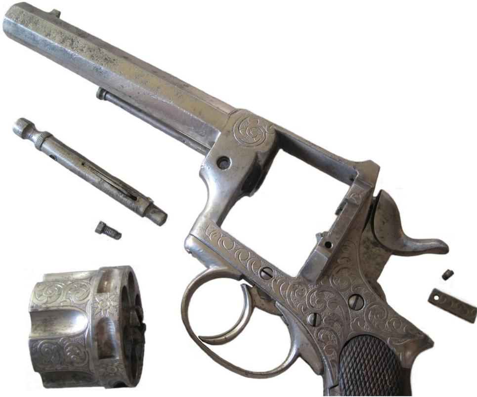
En este revolver, con varilla para la extracción manual de la última vaina, se diría no estaba prevista la extracción del tambor, que requiere no sólo la extracción del eje, también desprenderle de una platina fija al armazón por un diminuto tornillo.
