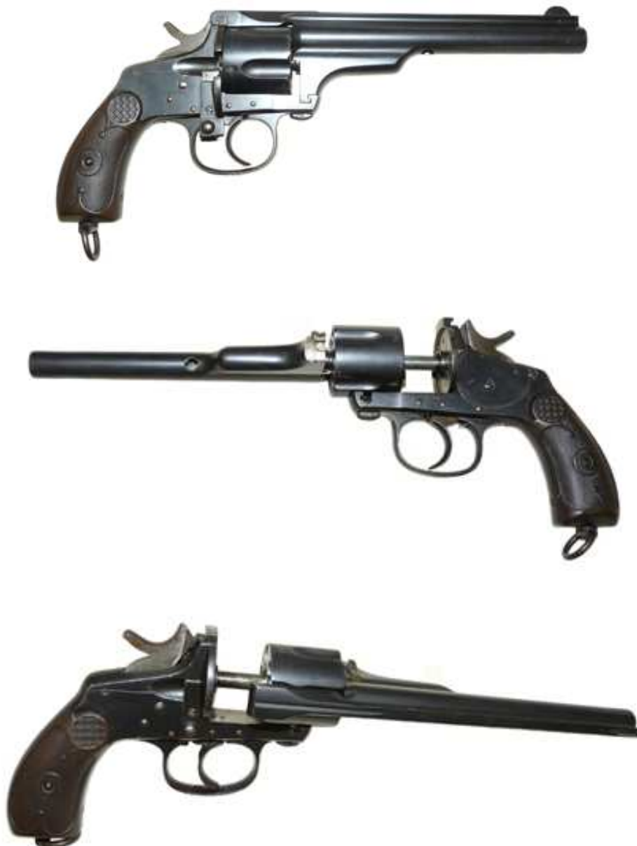
REVOLVER “MERWIN - HULBERT”, MODELO 1883, DOBLE ACCIÓN, SEIS TIROS, CALIBRE 38, CAÑÓN LONGITUD 140 mm. (5 ½”) MARCADO “MERWIN HULBERT & Co. NEW YORK / U.S.A. PAT. APR. 17.77 JUNE 15.80 MAR. 19.82 JAN 9.83”, NÚMERO 7936
