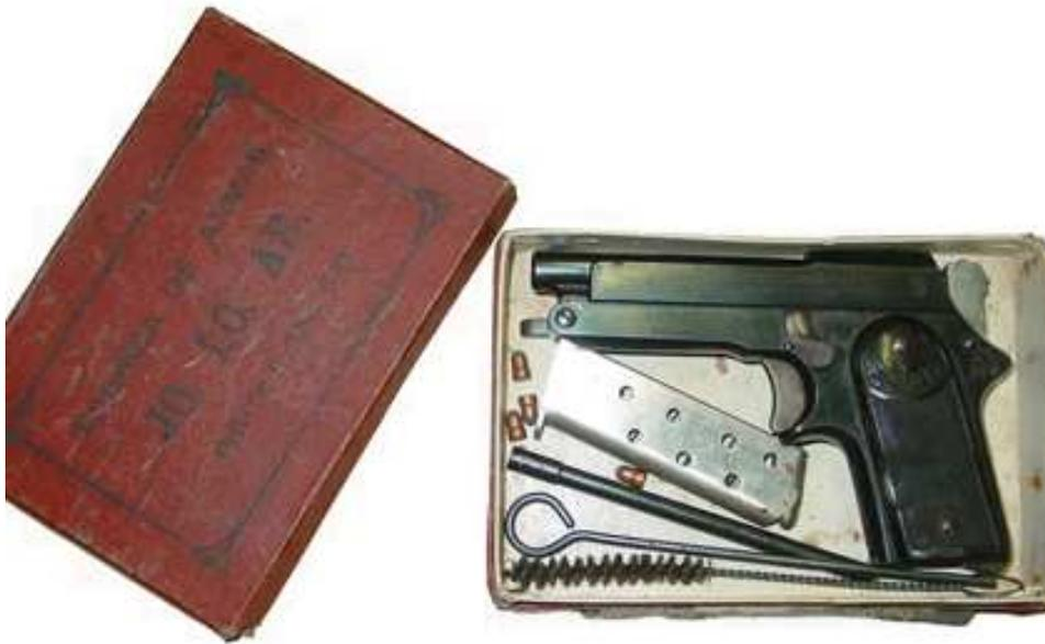
**PISTOLA “JO. LO. AR.”, Cal. 6,35 mm. EL TUBO REDUCTOR, PARA EL DISPARO DE CARTUCHOS Cal. 4 mm. M20, FIGURA ENTRE LOS ACCESORIOS INCLUIDOS EN LA CAJA QUE CONTIENE EL ARMA**
